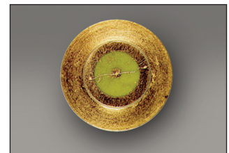
Air bag detonator module (squib wire)
