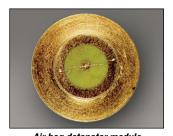
Air bag detonator module (squib wire)
